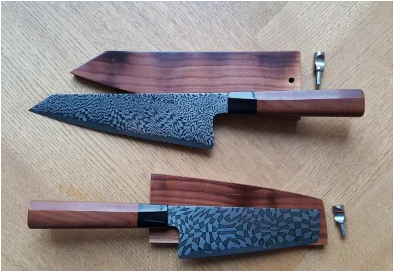
Mosaikdamastmesser, Messerschmiede Guldemann; Waldkirschholz für Griff und Messerscheide modifiziert zu Bijouwood durch Swiss Wood Solution.
